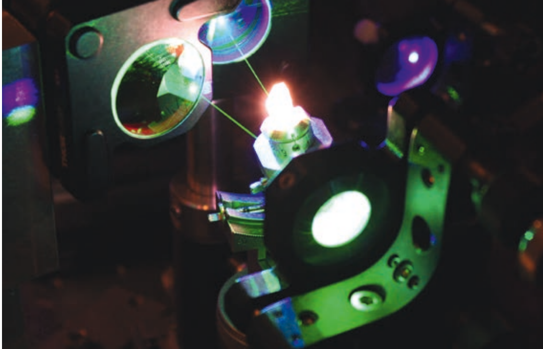
Grün emittierender einfach gefalteter Pr:YLF Laserresonator
