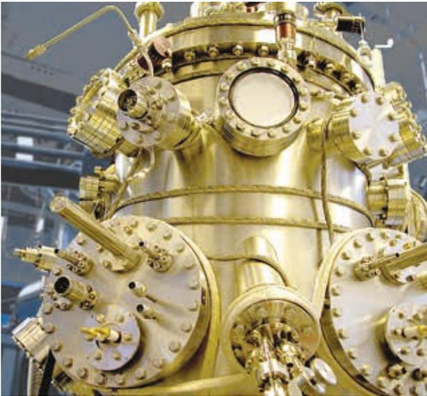
Molekularstrahlepitaxie (MBE): Anlage zur Abscheidung von Silizium und Silizium/Germanium-Nanostrukturen.
