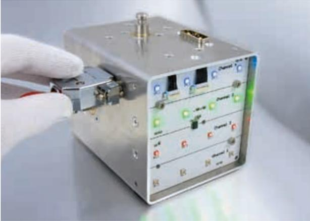
Modulares UV-LED-Bestrahlungssystem mit bis zu vier individuell einstellbaren Wellenlängen.
