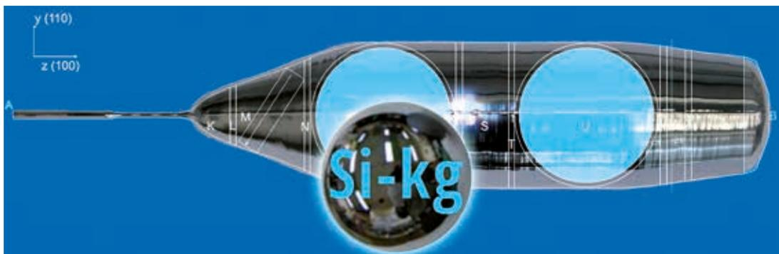
Schematische Darstellung eines im Kontext des KILOGRAMM-Projekts gezüchteten Prototyps eines Silizium-28-Einkristalls und daraus resultierender Kristallkugel von einem Kilogramm.
