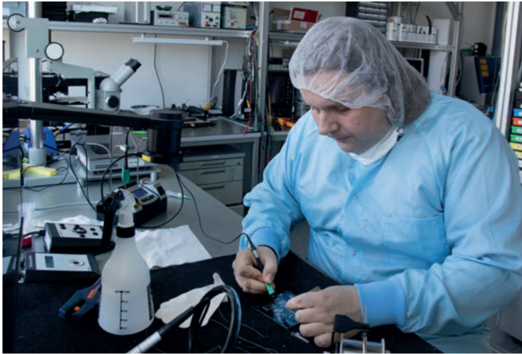
➊ Marco Spiesecke preparing a printed circuit board for integration into iSensU - with the IoT tool, data from older production plants without a digital interface can also be collected digitally. Marco Spiesecke beim Vorbereiten einer Leiterplatte zum Einbau in iSensU – mit dem IoT-Tool können auch die Daten älterer Anlagen ohne digitale Schnittstelle digital erfasst werden.
