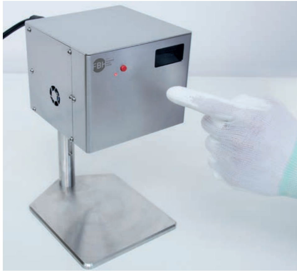
Prototype UVC LED system – designed to kill microorganisms on the skin without side effects. Prototyp des UVC-LED-Strahlers – damit sollen Mikroorganismen auf der Haut ohne Nebenwirkungen abgetötet werden.
