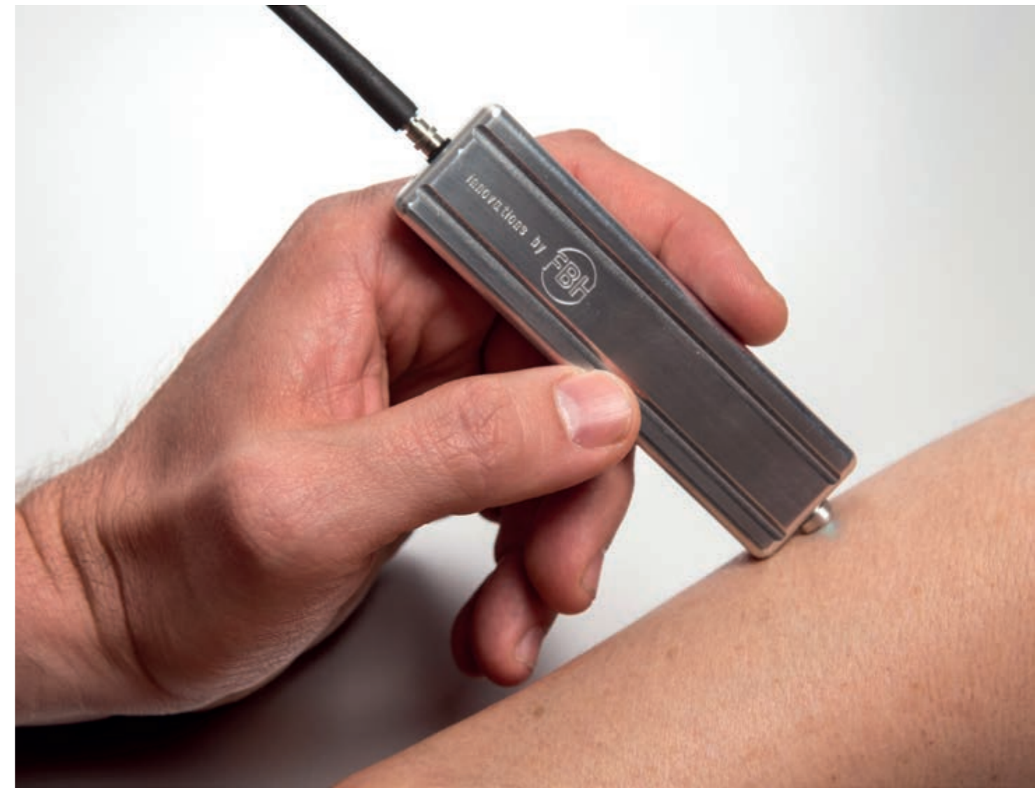
➊ Raman handheld probe to measure carotenoids on the skin. Raman-Optode zur Messung von Carotinoiden auf der Haut.
