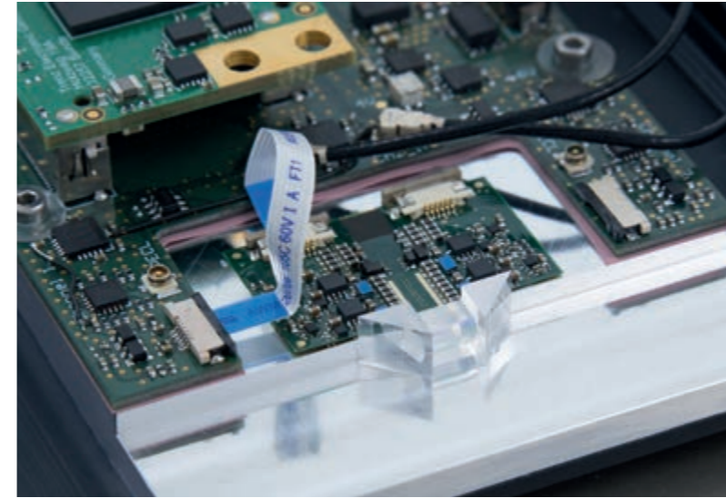
Single-emitter line scanner for automotive LiDAR – in the foreground one can see the vertical beam shaping of the pulsed diode laser source using a cylindrical lens. Einzelemittler-Linienscanner für Automotive LiDAR – vorne zu sehen ist die vertikale Strahlformung der gepulsten Diodenlaser-Quelle mittels einer Zylinderlinse.
