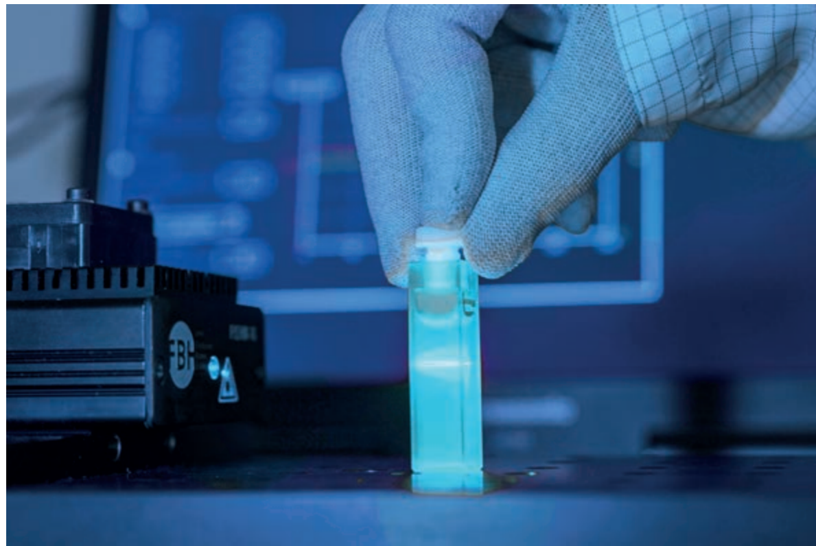
Dual-wavelength diode laser system for Raman measurements in operation. Zwei-Wellenlängen-Diodenlasersystem für Raman-Messungen im Betrieb.
